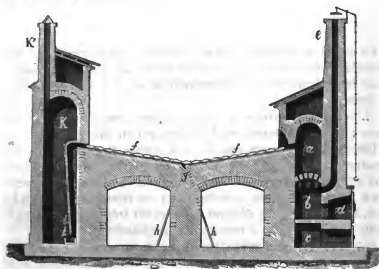
Fig. 180. — Traitement métallurgique du mercure à Almaden.
